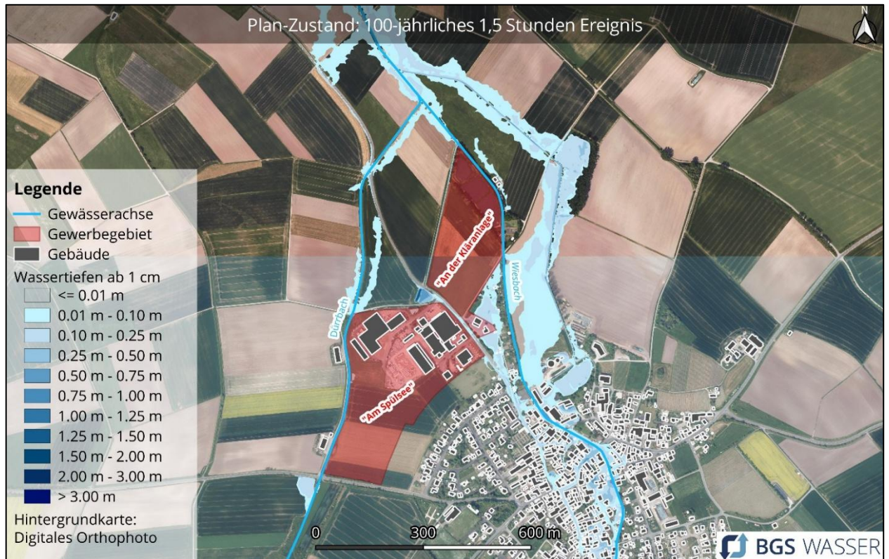
Abbildung 19: Übersicht der maximalen Wassertiefen des 100-jährlichen Ereignisses im Plan-Zustand
